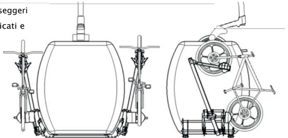
Rimozione rapida del rack per lo stoccaggio in cabina
